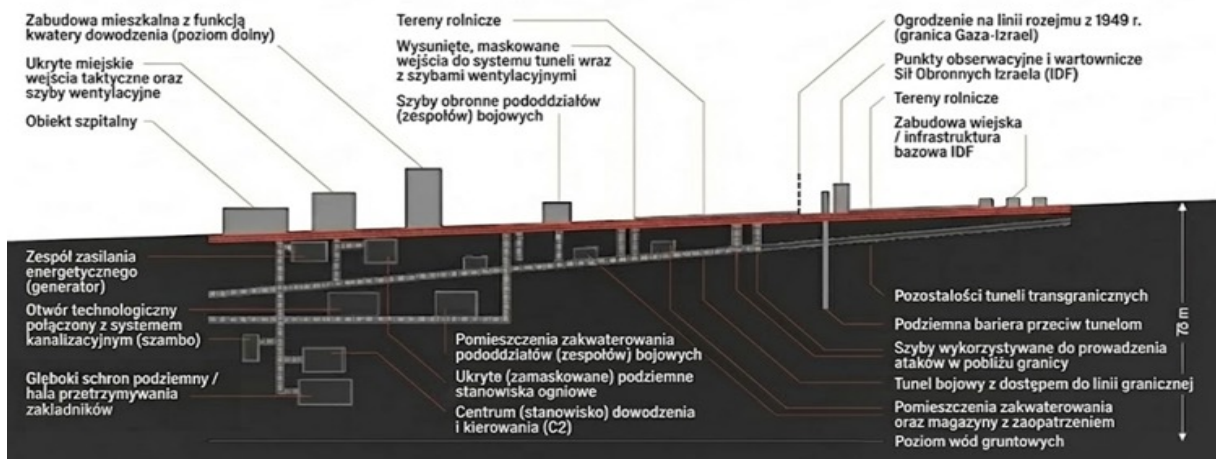
Rys. 6. Wizualizacja poszczególnych elementów systemu infrastruktury podziemnej Hamasu oraz ich rozmieszczenie przestrzenne
